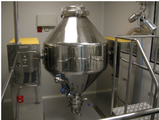
Mezclador bicónico con sistema de carga y descarga automático
